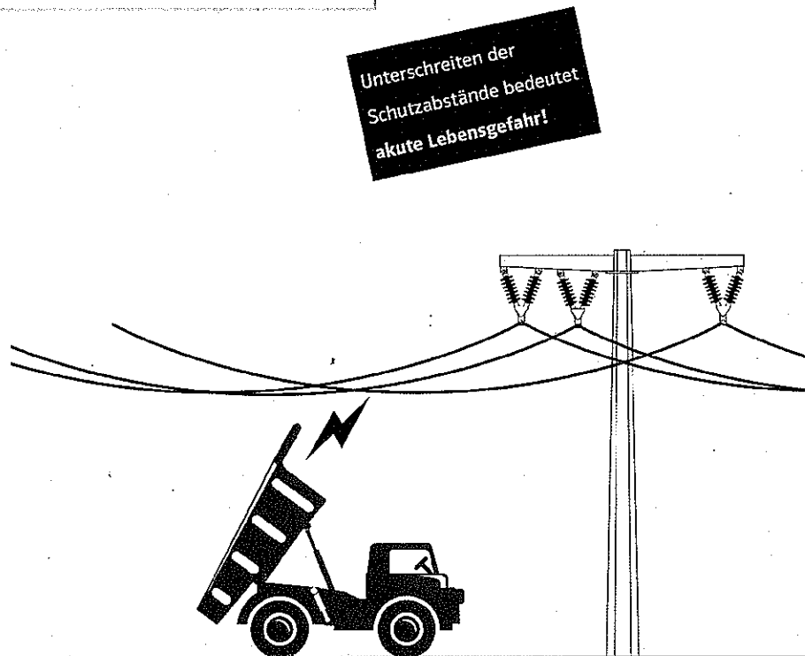
Abbildung 4: Berühren einer 20kV-Leitung beim Entleeren eines LKW
